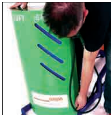
Wartungsarbeiten leicht gemacht: Mittels Dreikantschlüssel Verriegelung öffnen und Haube (Korpus) komplett abnehmen.
