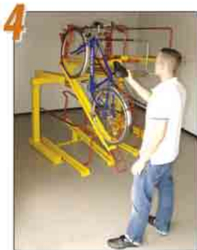
4 ... bis das Vorderrad im vorderen Sicherungsbügel Halt gegen seitliches Wegkippen findet und das Hinterrad gleichzeitig durch die eingebaute Rückrollsicherung arretiert wird.
