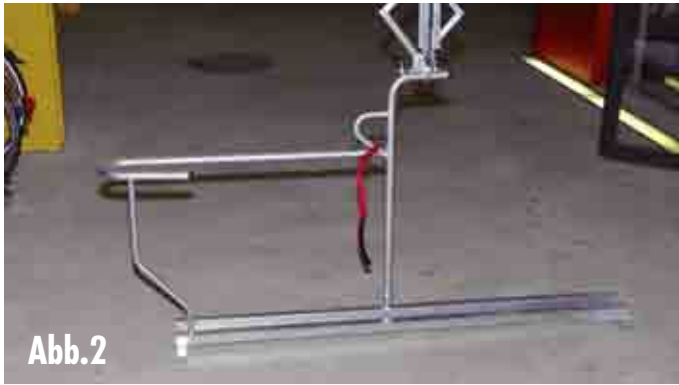
Abb.2 Fahrrad-Aufnahmesystem mit Klettband zur Rad-Fixierung
